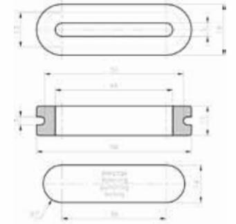
Служат для закрытия кабельных входов от проникновения пыли и грязи.
