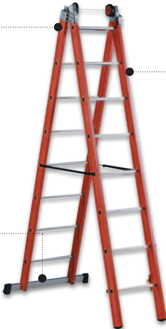
Стекловолоконные продольные рейки дают одновременно легкость и высокую надежность конструкции. Ребристые алюминиевые ступеньки трехкратно впрессованы в продольные рейки так, чтобы предотвратить прокручивание ступенек.
