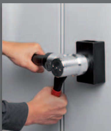
Гидравлический ручной пресс с поворотной головкой на 90° и 360°
